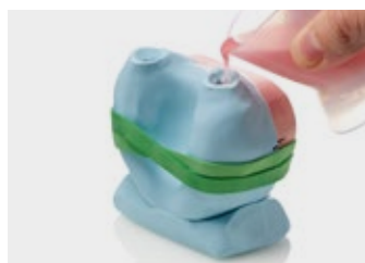
12. Wlać żywicę do jednego z kanałów wlewowych
