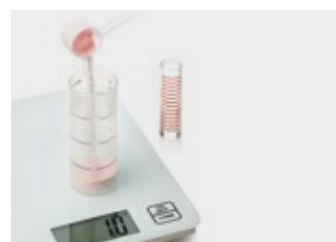
11. Zważyć polimer i odmierzyć monomer a następnie wymieszać, wysypując polimer do monomeru
