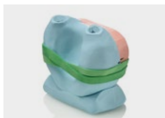
13. Nałożyć i zabezpieczyć przedlew w prawidłowej pozycji za pomocą gumki
