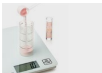
7. Zważyć polimer i odmierzyć monomer a następnie wymieszać wysypując polimer do monomeru
