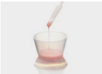
12. Wymieszać i oczekiwać do uzyskania konsystencji podobnej do miodu, jak pokazano na zdjęciu
