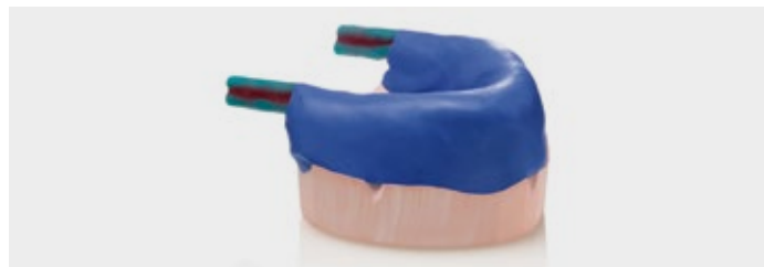
3. Pierwszy przedlew z Platinum 85 TOUCH, całkowicie pokrywający część woskową (pozwala to na bardzo dokładne odtworzenie modelowania w wosku)
