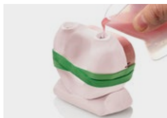
12. Wlać żywicę do jednego z kanałów wlewowych
