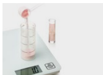
9. Zważyć polimer i odmierzyć monomeru, a następnie wymieszać, wsypując polimer do monomeru
