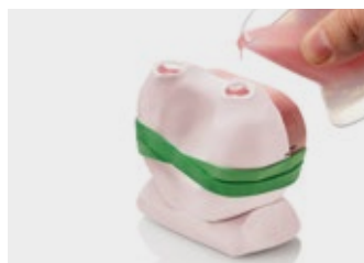
13. Odlewanie należy zakończyć, kiedy żywica wydostaje się z kanału po przeciwnej stronie
