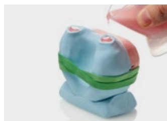
13. Odlewanie należy zakończyć, kiedy żywica wydostaje się z kanału po przeciwnej stronie
