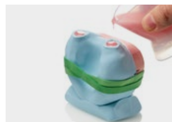
15. Odlewanie należy zakończyć, kiedy żywica zacznie wydostawać się z kanału po przeciwnej stronie
