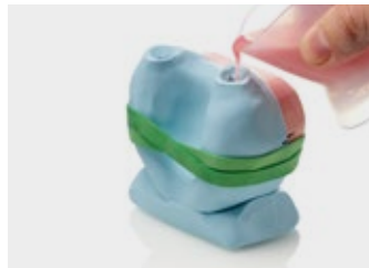
12. Wlać żywicę do jednego z kanałów wlewowych
