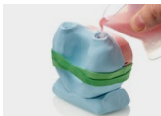
14. Wlać żywicę do jednego z kanałów wlewowych
