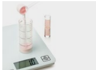
9. Zważyć polimer i odmierzyć monomer, a następnie wymieszać, wysypując polimer do monomeru
