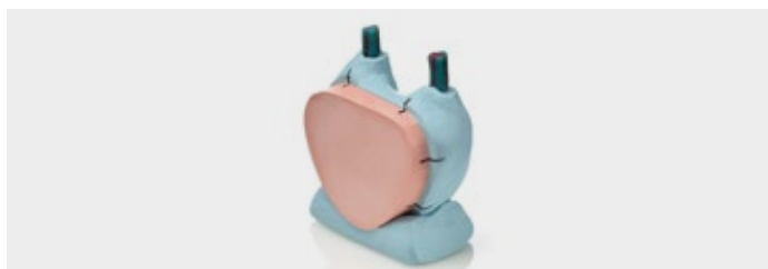
5. Wykonać podstawę z Platinum 95 w celu utrzymywania struktury w pozycji pionowej, zaznaczyć punkty orientacyjne w celu kontroli prawidłowej pozycji przedlewu
