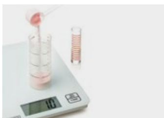
9. Zważyć polimer i odmierzyć monomer, a następnie wymieszać, wysypując polimer do monomeru
