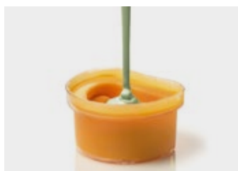
6. Wlać masę osłaniającą do silikonu
