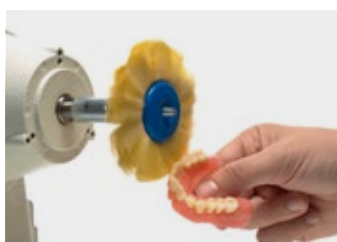
15. Polerowanie i wykańczanie
