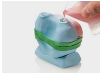
12. Verter el acrílico en uno de los dos canales de vaciado
