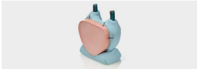
5. Construcción base en Platinum 95 para mantener la estructura en posición vertical, marcado de puntos de referencia para controlar la correcta recolocación de la silicona
