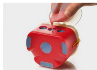
12. Verter la resina en el canal de vaciado central
