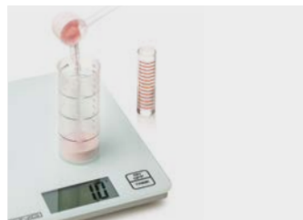
7. Pesar la resina, medir el monómero, mezclar vertiendo primero el monómero y después la resina
