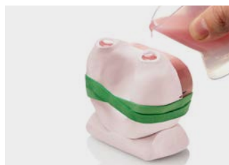
13. Fin del vaciado a la salida de la resina del canal opuesto
