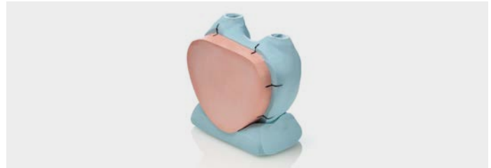
7. Construcción de la base de Platinum 95 para mantener la estructura en posición vertical, marcado de los puntos de referencia para controlar la correcta reubicación de la silicona
