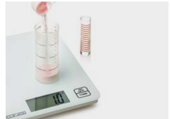
11. Pesar la resina, medir el monómero, mezclar vertiendo primero el monómero y después la resina
