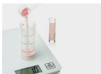
9. Pesar la resina, medir el monómero, mezclar vertiendo primero el monómero y después la resina
