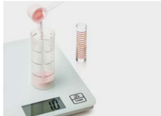
6. Pesar la resina, medir el monómero, mezclar vertiendo primero el monómero y después la resina
