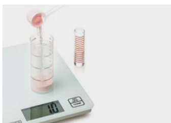
9. Pesar la resina, medir el monómero, mezclar vertiendo primero el monómero y después la resina
