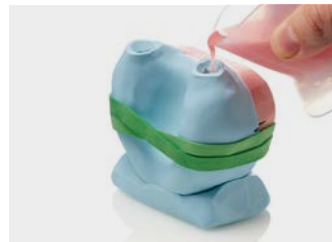
14. Verter la resina en uno de los dos canales de vaciado
