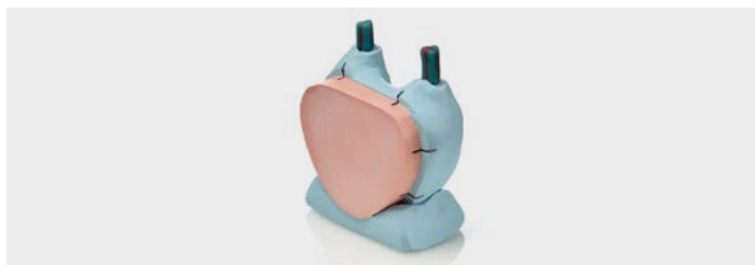
5. Costruzione base in Platinum 95 per mantenere la struttura in posizione verticale, marcatura punti di repero per controllare il corretto riposizionamento del silicone
