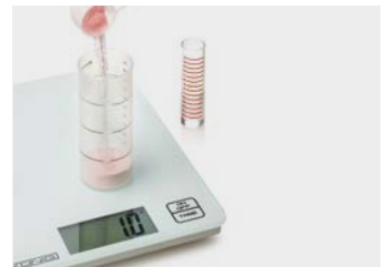
11. Pesare la resina, misurare il monomero, miscelare versando prima il monomero e poi la resina
