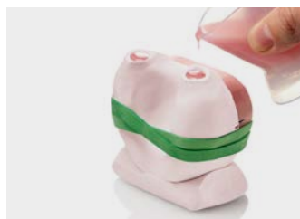
13. Fine della colata alla fuoriuscita della resina dal canale opposto
