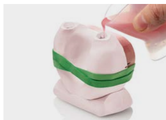
12. Versare la resina in uno dei due canali di colata
