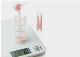
6. Pesare la resina, misurare il monomero, miscelare versando prima il monomero e poi la resina
