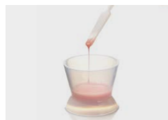
8. Miscelare e attendere fino ad avere una consistenza «mielosa» come da foto
