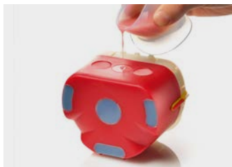
13. Fine della colata alla fuoriuscita della resina dai canali laterali
