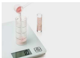
9. Pesare la resina, misurare il monomero, miscelare versando prima il monomero e poi la resina
